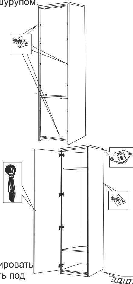
На двери установить ручки. Отрегулировать двери, при необходимости установить под ножки пластиковые подставки.
