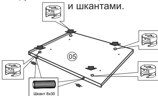
В отверстия на пласти вертикальных стенок 03 и 04 установить по 6 соединительных винтов с метрической резьбой и по 2 ввинчиваемых дюбеля.
