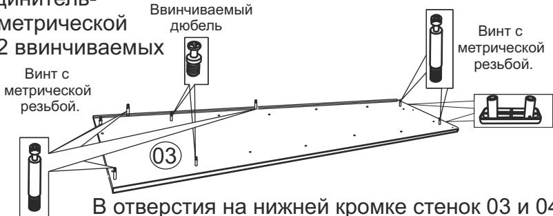
В отверстия на нижней кромке стенок 03 и 04 установить 2 наконечника. Стенку вертикальную звинчиваляемый дюбель Ввинчиваляемый дюбель 04 оборудовать 4-мя ответными планками D-0
